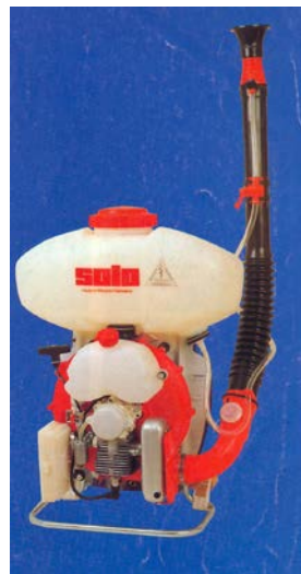
ภาพที่ 23 แสดงส่วนประกอบของเครื่องยนต์สารสะพายหลังชนิดใช้แรงลม
