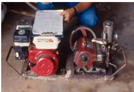
ภาพที่ 13 เครื่องยนต์พ่นสารแบบใช้แรงดันน้ำสูง ประเภทสองคนหามและติดตั้งล้อเข็น
