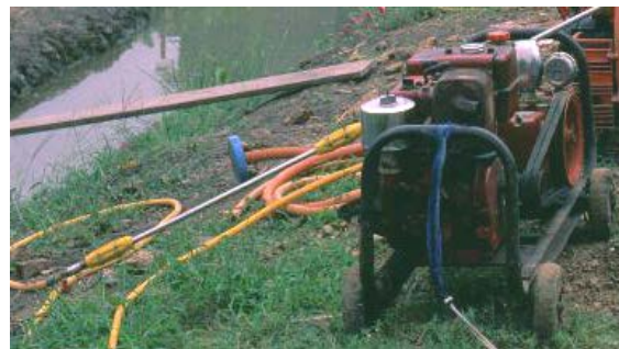
ภาพที่ 13 เครื่องยนต์พ่นสารแบบใช้แรงดันน้ำสูง ประเภทสองคนหามและติดตั้งล้อเข็น
