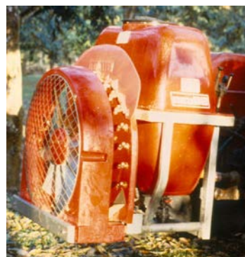
ภาพที่ 24 แสดงการทำงานของพัดลมแบบ axial fan
