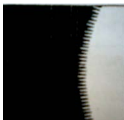
ภาพที่ 30 แสดงการเกิดของละอองสารจากการเหวี่ยงของแผ่นจานหมุน
