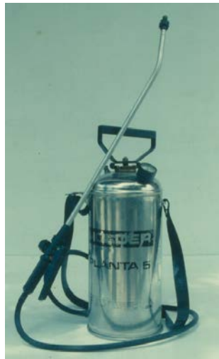
ภาพที่ 4 เครื่องพ่นสารแบบชนิดถังอัดลม แบบทำด้วยโลหะ(ซ้าย) และพลาสติก(ขวา)
