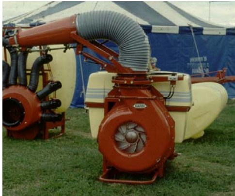
ภาพที่ 25 ลักษณะของพัดลมแบบ radial fan หรือ centrifugal fan
