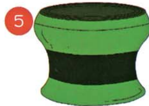
5 ใช้ไม้ที่แกะสลักเป็นลวดลาย หรือรูปสัตว์กดบนขี้ผึ้งที่พอกไว้ให้เป็นรอย Decorated on wax surface with figures and motif imprint
