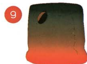
9 เจาะรูที่ฐานกลองให้น้ำขี้ผึ้งไหลออก มาระหว่างเผาด้วยความร้อนสูง Make a hole on drum base to lose wax during heating
