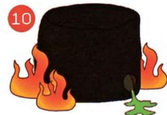
10 นำแม่พิมพ์ไปเผาไฟให้ขี้ผึ้งละลาย ไหลออกจนหมดและเทโลหะสำริดลงใน ช่องแทนที่ขี้ผึ้ง ในขณะที่ดินยังร้อนอยู่ Burned mold with high temperatures, lose wax and poured bronze compounds instead
