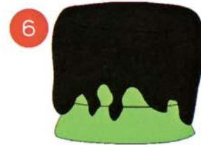
6 นำดินเหนียวแห้งตำให้ละเอียด กรองด้วยผ้า พอกบนขี้ผึ้ง 3 ชั้น Pounding dry clay and filters with cloths, topped on wax surface for 3 times
