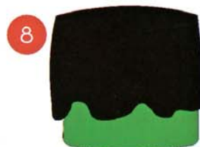
8 ใช้ดินเหนียวผสมแกลบพอกทับ หนา 3 นิ้ว แล้วทิ้งไว้ให้แห้ง Mixed clay and chaff, covered for 3 inch thick and leave to dry
