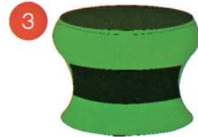
3 ใช้ดินเหนียวผสมขี้วัวพอกทับ อีกชั้นให้เรียบเสมอกัน ทิ้งไว้ให้แห้ง Mixed clay and bull shit, covered a layer and leaved to dry
