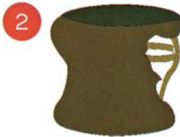
2 ใช้ดินเหนียวผสมแกลบพอกที่ โครงไม้ให้ทั่ว Mixed clay and chaff, covered bamboo structure
