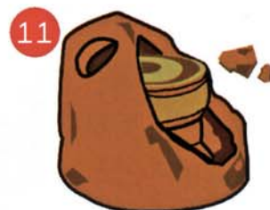
11 ทิ้งไว้จนเย็นแล้วทุบแม่พิมพ์ดินออก Leaved mold until cool and broke out clay
