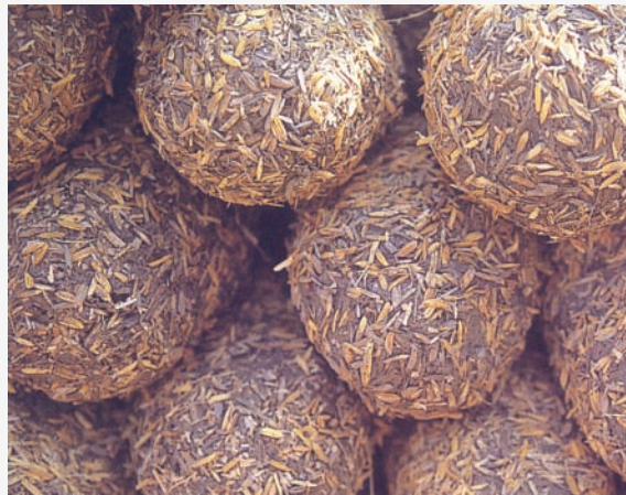
ก้อนดินเชื้อที่ผสมดินเหนียวกับแกลบ ปั้นเป็นก้อนกลมก่อนนำไปเผา แล้วนำมาบดผสมกับดิน
