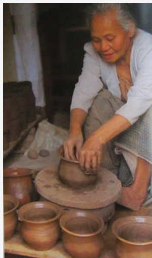
การขึ้นรูปโดยใช้แป้นหมุนเป็นวิธีที่ได้รับความนิยมจนถึงปัจจุบัน
