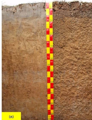
ภาพที่ 4-2 การรองผ้าเทปด้วยแผ่นกระดานแข็ง เพื่อช่วยให้ผ้าเทปตั้งฉาก (ก) การฉีดพ่นหน้าตัดดินด้วยกระบอกพ่นยาอัดลม (ข) หน้าตัดดินที่ตกแต่งเสร็จเรียบร้อยแล้ว (ค)
