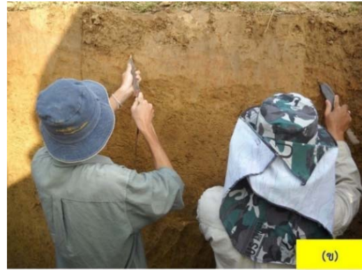
ภาพที่ 4-1 หลุมเพื่อศึกษาชุดดินขนาด กว้างxยาวxลึก = 2x2x2 เมตร (ก) และการตกแต่งหน้าตัดดิน (ข)
