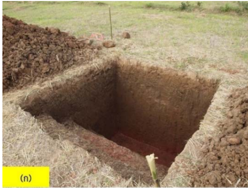
ภาพที่ 4-1 หลุมเพื่อศึกษาชุดดินขนาด กว้างxยาวxลึก = 2x2x2 เมตร (ก) และการตกแต่งหน้าตัดดิน (ข)
