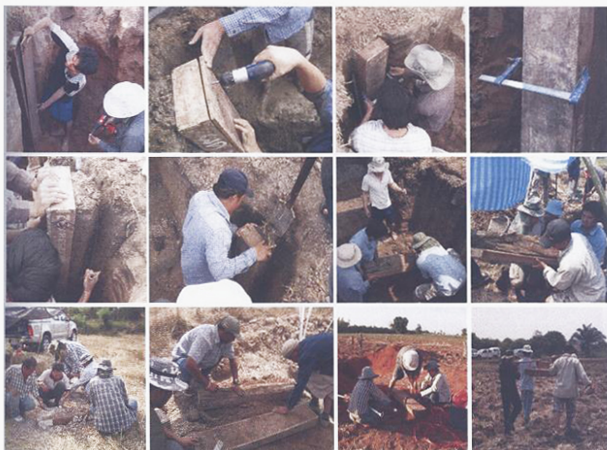
ภาพที่ 5-6 (ต่อ) วิธีการเก็บแท่งตัวอย่างดิน (2)
