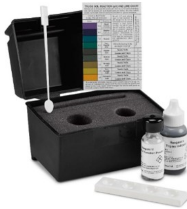
ภาพที่ 4-45 ชุดวัดปฏิกิริยาดินในสนาม
