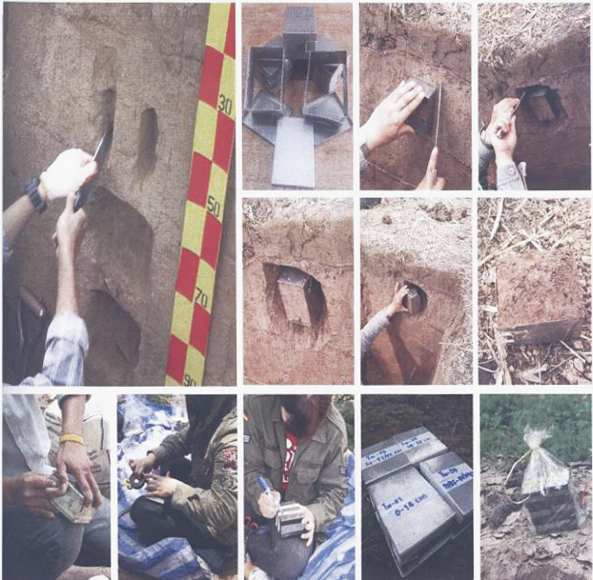
ภาพที่ 5-4 การเก็บตัวอย่างดินโดยใช้ Kubiena box
