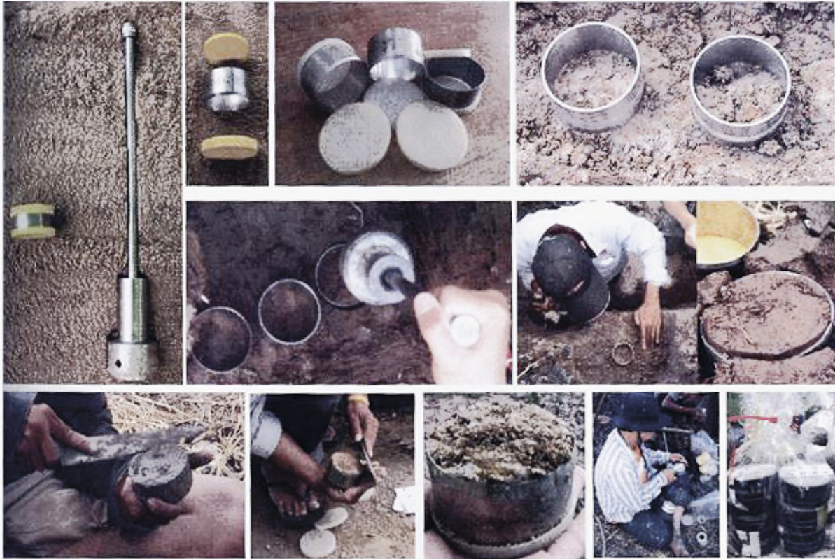
ภาพที่ 5-3 การเก็บตัวอย่างดินแบบ core method
