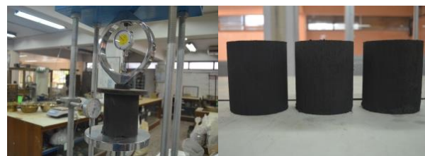
6. ทดสอบกำลังรับแรงอัดแกนเดียว (Unconfined Compression Test)
