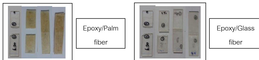
ภาพที่ 3 คอมพอสิตอีพอกซีเสริมเส้นใยทะเลลายปาล์มน้ำมันและเสริมเส้นใยแก้วปริมาณต่าง ๆ (0-10%)
