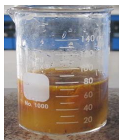
สกัดเอนไซม์ด้วยบัฟเฟอร์ Tris-HCl pH 9.0
