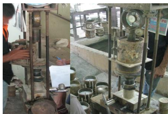
7. ทดสอบกำลังรับแรงแบกทาน (California Bearing Ration: CBR)
