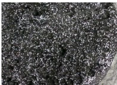
ภาพที่ 3 ลักษณะส่วนผสมของคอนกรีตบล็อกมวลเบา ที่มีเก่าปาล์มน้ำมันและเม็ดโฟม
