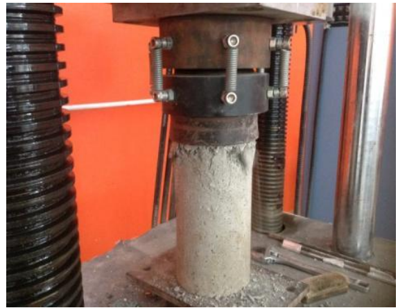
ภาพที่ 5 การทดสอบความต้านทานของแท่งคอนกรีตแรงอัด
