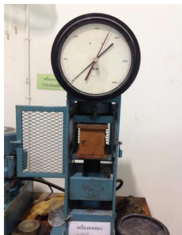
ภาพที่ 2 แสดงการทดสอบการรับแรงอัด
