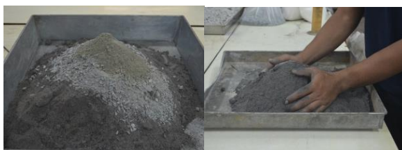
3. ผสมถ้ำปาล์มน้ำมัน เศษหินบะชอลต์และปูนซีเมนต์ ปอร์ตแลนด์ ประเภท 1 ให้เข้ากัน
