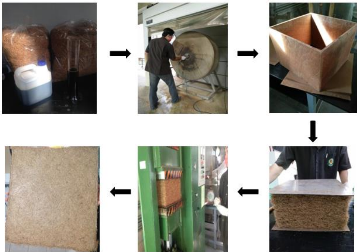
ภาพที่ 1 กระบวนการขึ้นรูปแผ่นตัวอย่าง
