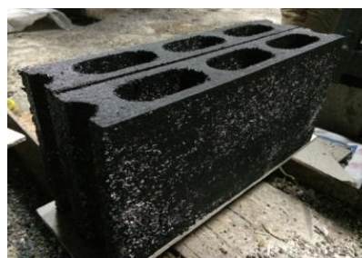
ภาพที่ 4 คอนกรีตบล็อกมวลเบาผสมเก่าปาล์มและเม็ดโฟม สำหรับนำไปป้อนและทดสอบสมบัติต่างๆ
