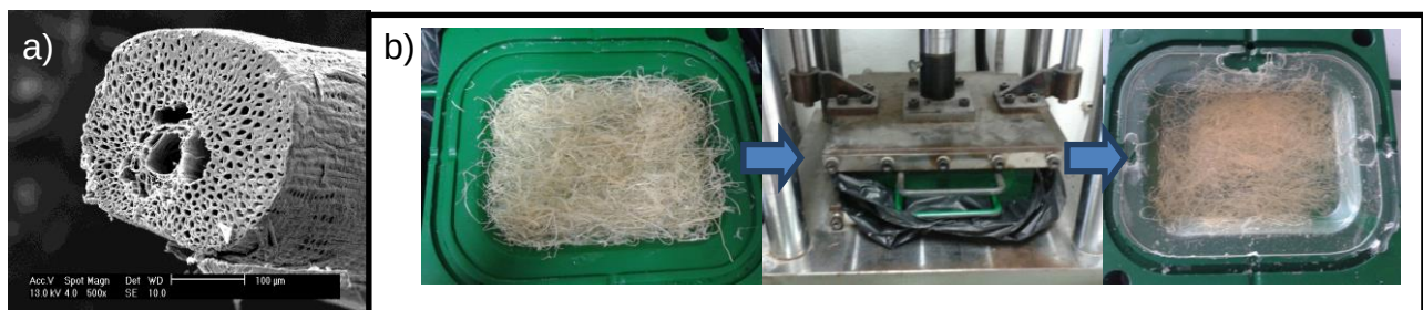
ภาพที่ 1 a) ภาพถ่าย SEM พื้นที่หน้าตัดของเส้นใยทะเลลายปาล์มน้ำมันหลังสกัดด้วยวิธีทางเคมี b) การเตรียมคอมพอสิตอีพอกซีเสริมเส้นใยทะเลลายปาล์มน้ำมัน
