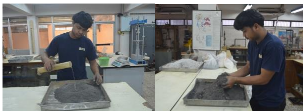
4. ผสมน้ำลงในส่วนผสมที่ประกอบด้วยถ้ำปาล์มน้ำมัน เศษหินบะชอลต์และปูนซีเมนต์ปอร์ตแลนด์ ประเภท 1
