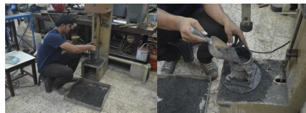
5. บดอัดตัวอย่าง (ถ้ำปาล์มน้ำมัน เศษหินบะชอลต์และ ปูนซีเมนต์ปอร์ตแลนด์ ประเภท 1) ที่ผสมกับน้ำใน ปริมาณที่เหมาะสม
