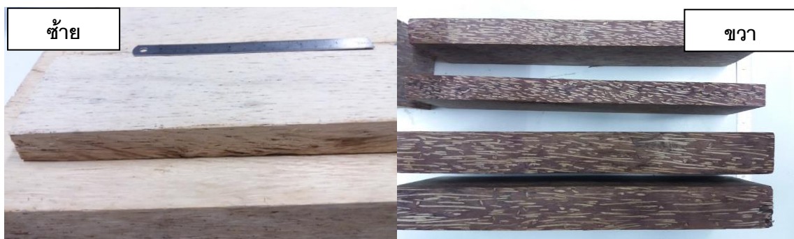
ภาพที่ 2 เนื้อไม้อัดด้วยการยูเรียฟอร์มัลดีไฮด์ (ซ้าย) และ เนื้อไม้อัดด้วยการฟีนอลฟอร์มัลดีไฮด์ (ขวา)
