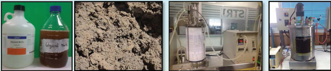
ภาพที่ 1 กลีเซอรอลดิบ กากตะกอนดีแคนเตอร์ ถังหมักขนาด 5 ลิตร และถังหมักขนาด 20 ลิตร
