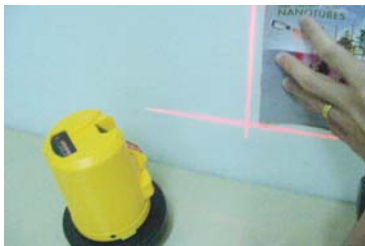
เครื่องวัดเส้นแสงสำหรับบอกระดับในแนวนอน และแนวตั้ง
