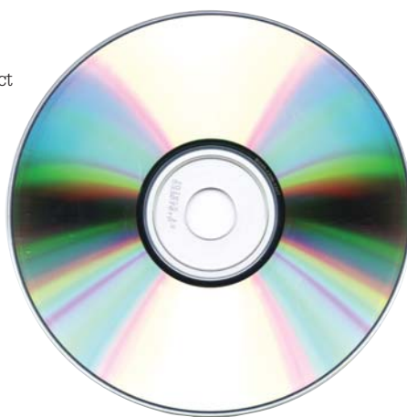
สีรุ้งที่เกิดจากการเลี้ยวเบนของแสงบนแผ่นซีดี
