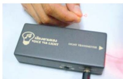
ชุดส่งข้อมูลเสียงผ่านแสงสำหรับใช้ในการเรียนการสอน
