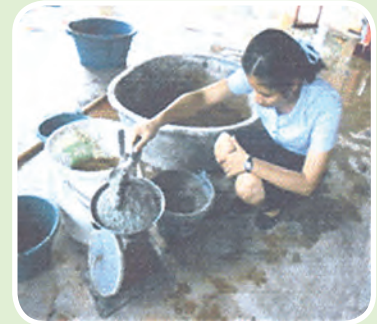
รูปที่ 5 ชั่งอัตราส่วนผสม ปูน : ทราย : ดิน : เปลือกทุเรียน
