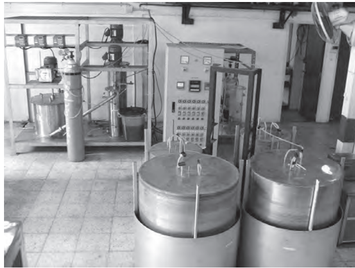
รูปที่ 10 ระบบผลิตก๊าซชีวภาพจากเศษผักสดเหลือทิ้ง
