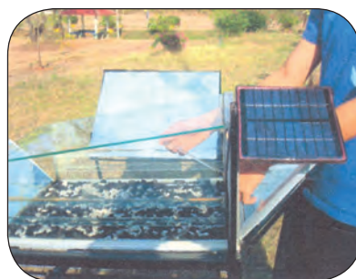
รูปที่ 11 ใส่ถาดชั้นล่าง ใส่ก้อนหินชั้นบน
