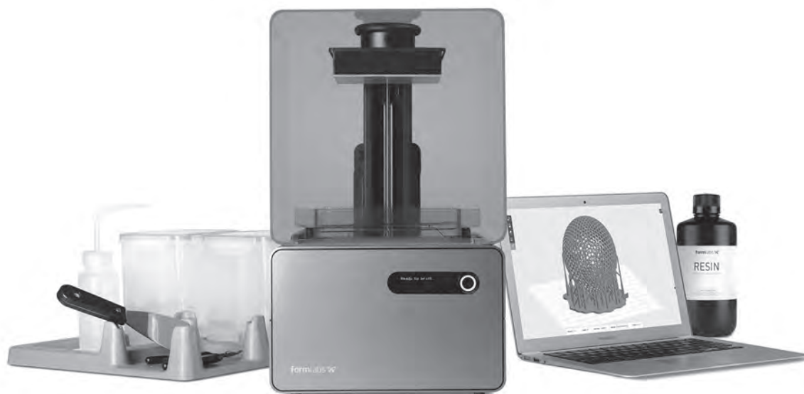
Form 1+ เครื่องพิมพ์สามมิติแบบ SLA สำหรับผู้ใช้ตามบ้าน จาก formlabs
