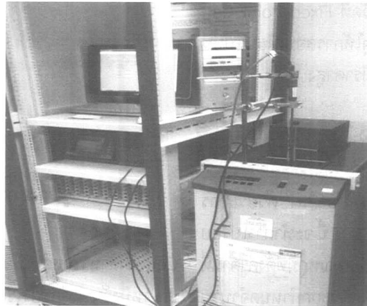
รูปที่ 2 การสอบเทียบ PRT ด้วยการเปรียบเทียบกับ SPRT
