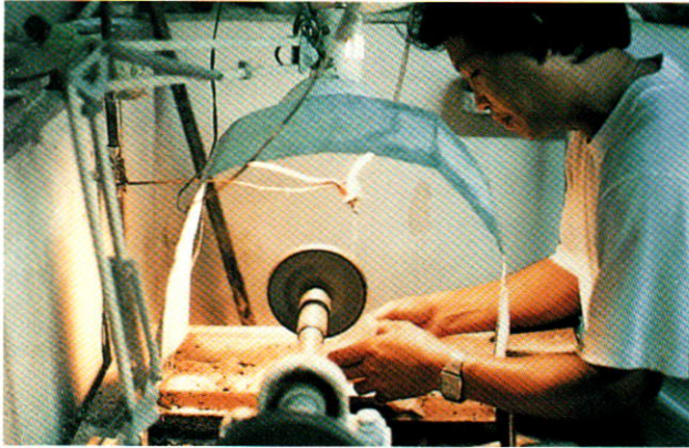
ช่างใช้เครื่องมือขัดแก้วผลึกจนกระทั่งมีลักษณะโปร่งแสง ซึ่งต้องอาศัยน้ำอย่างดี ตลอดจนฝีมือและสมาธิที่แน่นของช่าง
