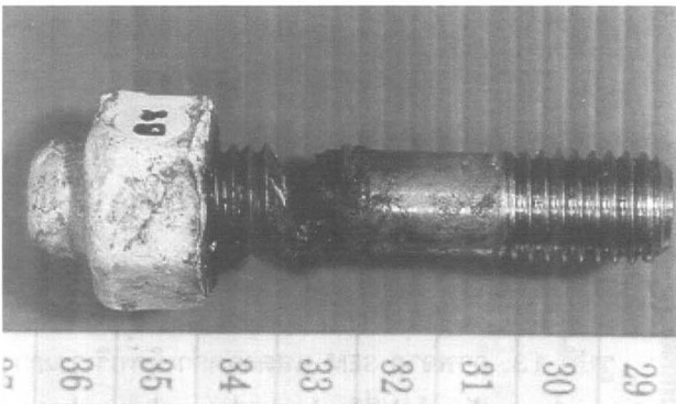
รูปที่ 11. Stud Bolt ที่มีการกัดกร่อนและแตกหักจนเกือบขาด
