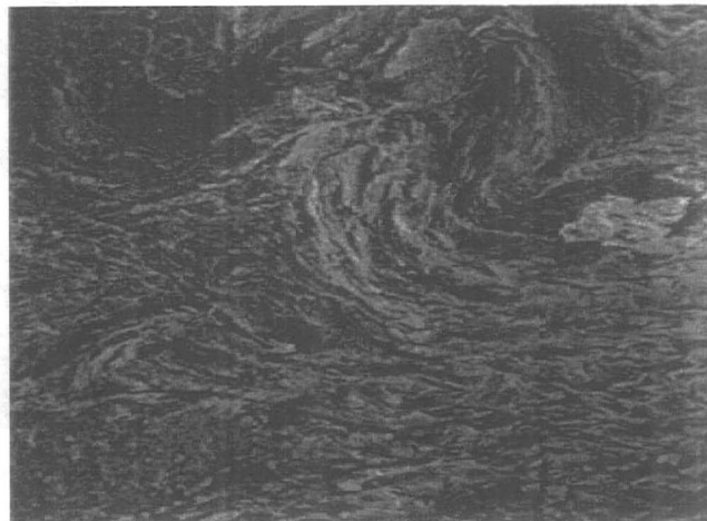
รูปที่ 6 โครงสร้างจุลภาคของ Takahata kaolin บดอัดด้านเปียก โดยใช้ impact compaction x 1000 (Yoshinaka and Kazama, 1973)
