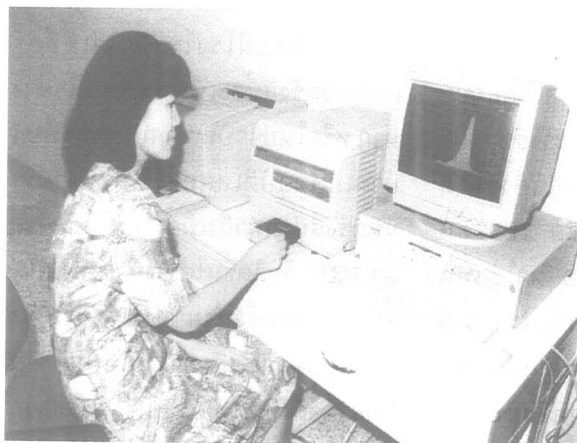
รูปแสดงเครื่องอ่านปริมาณแสงที่ปล่อยออกมาจาก TLD
