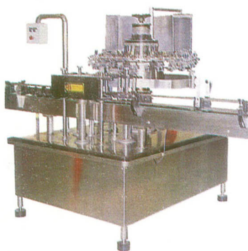
ROTARY RINSER MACHINE เครื่องล้างขวดระบบโรตารี 24 หัว
