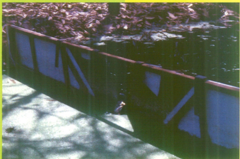
ภาพที่ 1. แสดงฝายวัดน้ำสันคมรูปสามเหลี่ยม 60 องศา
