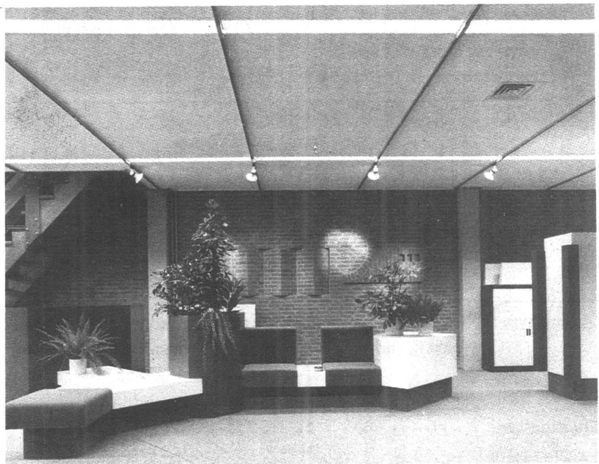
รูปที่ 4. การใช้หลอดไฟทังสเตน ฮาโลเจน ที่ประกอบเป็นชุดกับอุปกรณ์บังคับแสงสำหรับการให้แสงสว่าง
