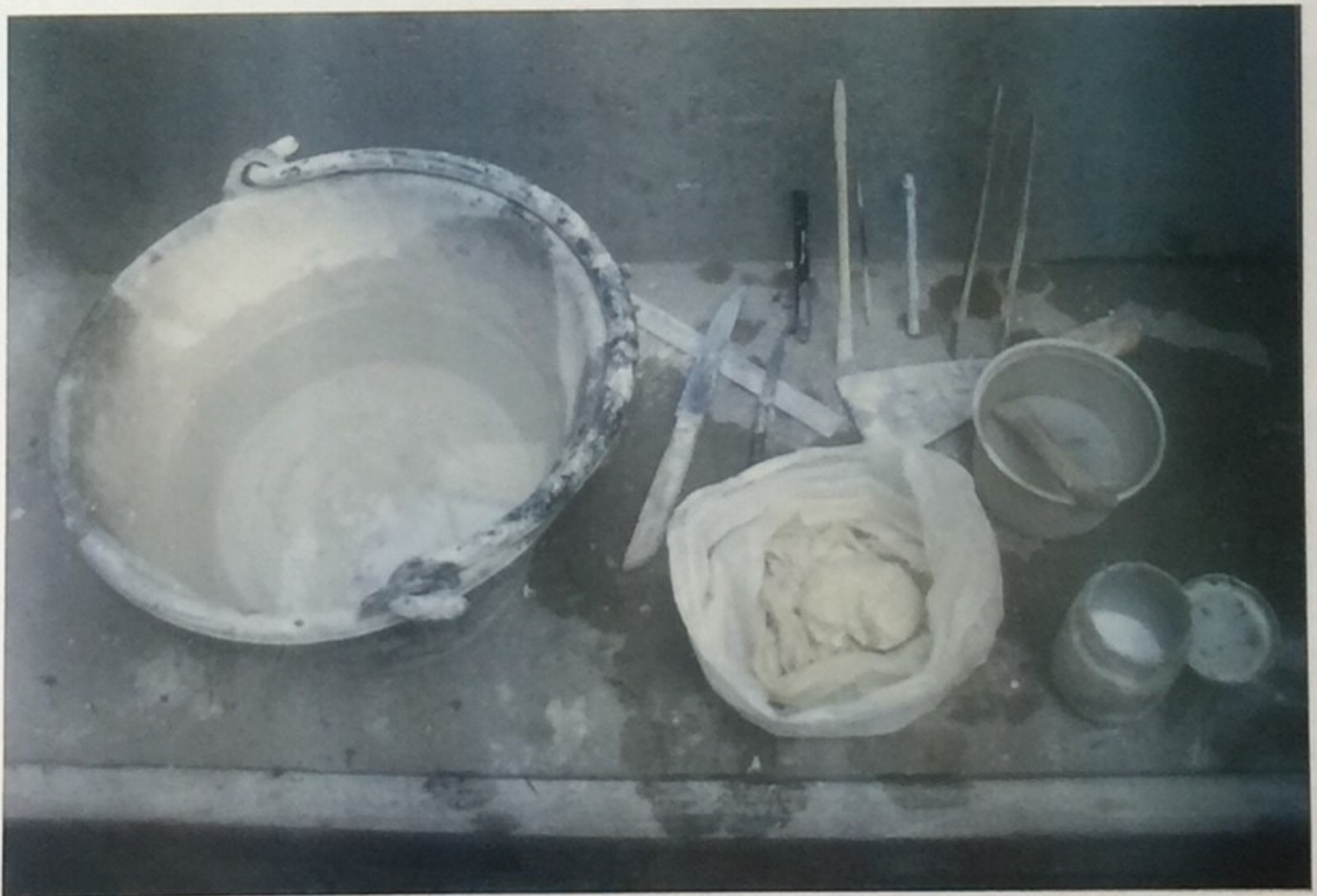
วัสดุ ปูนเพชร(ปูนดำหรือปูนสด) น้ำกาวหนังควาย ส่วน อุปกรณ์ พื้นบ้านอย่างเรียบง่าย
