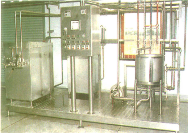
โรงนมพาสเจอร์ไรส์ มีขนาด 350-1,000 ลิตร/ชม. Milk Pasteurized plant 350 L/Hr
