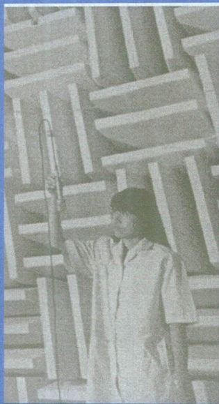
ห้องไว้เสียงสะท้อนสำหรับสอบเทียบอุปกรณ์เสียงที่ทันสมัย
