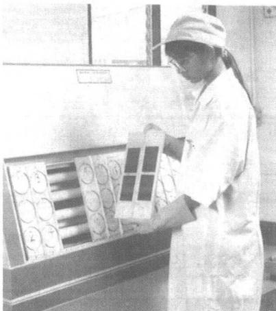
2.3 กำหนดให้ ด้านบนของเครื่องอั่งน้ำเป็นทิวังแผ่นทดสอบ โดยทำมุนเอยง  $15 \pm 5$  องศา กับแนวโน้มในการสร้างเครื่องมือได้ติดตั้งเท่่แก้ว 3 อันให้ยาวนานกัน ในด้านที่ข่าน กับความยาวของกล่อง โดยให้เท่่แก้วอันหนึ่งอยู่สูงกว่าเท่่แก้วอีก 2 อัน ซึ่งทำให้สามารถวางแผ่นทดสอบได้มุนเอยง  $15 \pm 5$  องศา กับแนวโน้ม และเมื่อวางแผ่นทดสอบพอดานเท่่แก้วโดยให้แต่ละแผ่นอยู่ห่างกันประมาณ 2 มม. แล้ว น้ำที่ควบแน่นสามารถไหลกลับลงไปในเครื่องมือโดยไม่ไหลจากแผ่นทดสอบแผ่นหนึ่งไปถึงอีกแผ่นหนึ่ง
