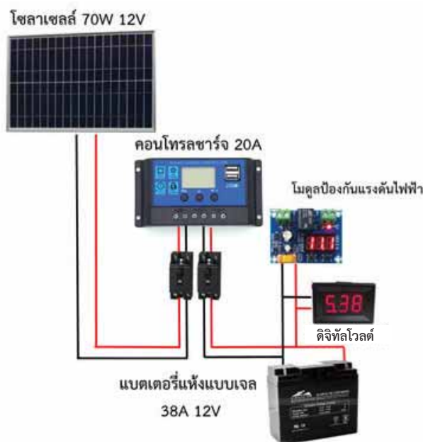
ภาพที่ 6 ระบบชาร์จโซลาร์เซลล์ และป้องกันแรงดันไฟฟ้าของแบตเตอรี่
