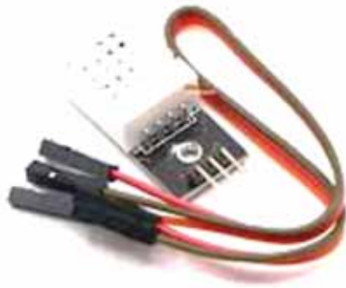
ภาพที่ 10 แสดงเซนเซอร์ DHT22/AM2302 สำหรับวัดอุณหภูมิและความชื้นสัมพัทธ์
