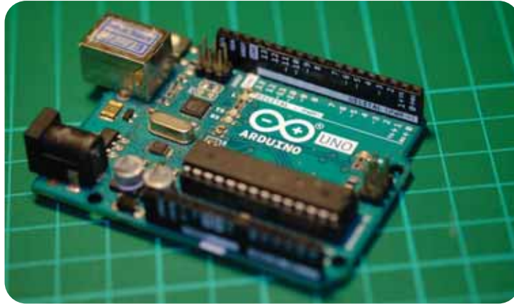
ภาพที่ 5 บอร์ดสมองกลฝังตัว Arduino
