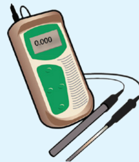
เครื่องวัดความเป็นกรด-ด่าง (pH-meter) ใช้วัดค่าความเป็นกรด-ด่าง ของอาหารเพาะเลี้ยง
