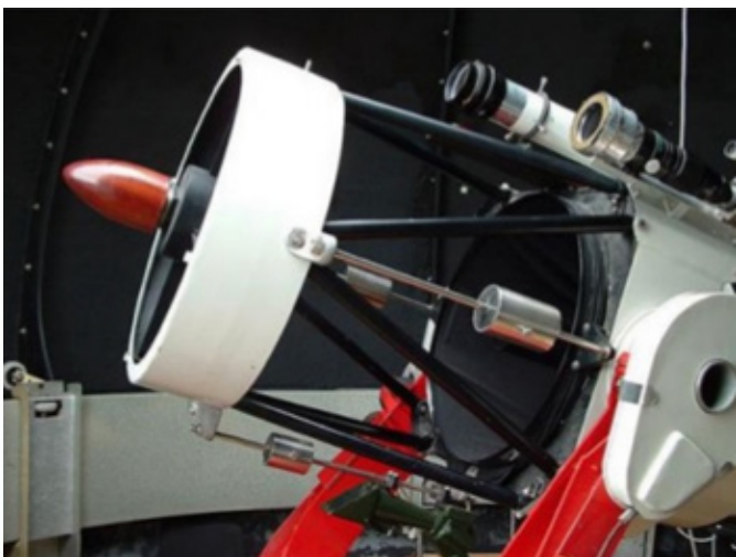
ภาพกล้องโทรทรรศน์ที่ใหญ่ที่สุดในเวลส์ 500-mm Shafer-Maksutov telescope เป็นกล้องโทรทรรศน์แบบผสม "Catadioptric telescope" ขอบคุณภาพจาก https://www.slideshare.net/operacrazy/shafer-maksutov-telescope
