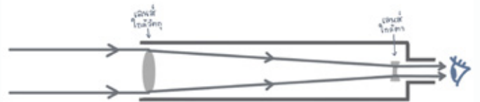
ภาพแสดงหลักการทำงานของกล้องโทรทรรศน์แบบหักเหแสง "Refractor telescope"
