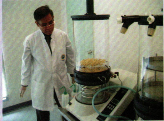
ทดลองทำกระดูกอัดเม็ดด้วยเครื่องอัดเม็ดยาแล้วทำ แท่งด้วยความเย็น เพื่อศึกษาลักษณะทางกายภาพ ของเม็ดกระดูก วันที่ ๒๔ มิถุนายน ๒๕๔๔
