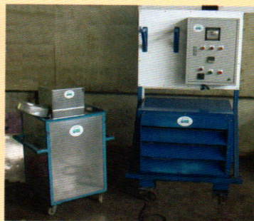
รางวัลนวัตกรรมเทคโนโลยีดีเด่น ประจำปี ๒๕๕๘ การออกแบบอุปกรณ์กระจายความชื้นแบบจุ่มชนิด ดราฟต์หัวบีบนเซลคอยล์สำหรับถังบรรจุและขนถ่าย น้ำนมดิบ
