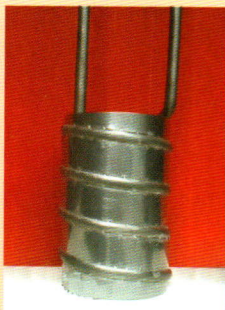
รางวัลนวัตกรรมเทคโนโลยีดีเด่น ประจำปี ๒๕๕๘ การออกแบบอุปกรณ์กระจายความชื้นแบบจุ่มชนิด ดราฟต์หัวบีบนเซลคอยล์สำหรับถังบรรจุและขนถ่าย น้ำนมดิบ
