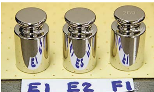
รูปที่ 1 ต้มน้ำหนักผลิตจากสเตนเลสสตีลที่ส่วนผสมภายในต่างกัน โดยต้มน้ำหนักต่างกัน คือ E1 > E2 > F1
