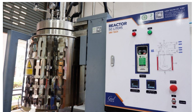
ระบบปฏิกรณ์แรงดันสูงขนาด Bench-scale สำหรับสังเคราะห์ตัวเร่งปฏิกิริยาและวัสดุคูดซับนาโน
