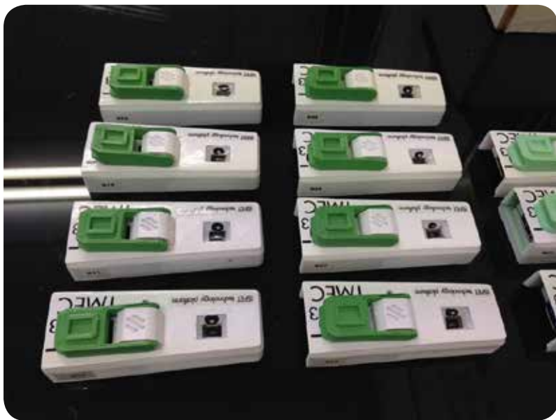
หัววัดไนเตรทเซนเซอร์บนฐานเทคโนโลยี ISFET
