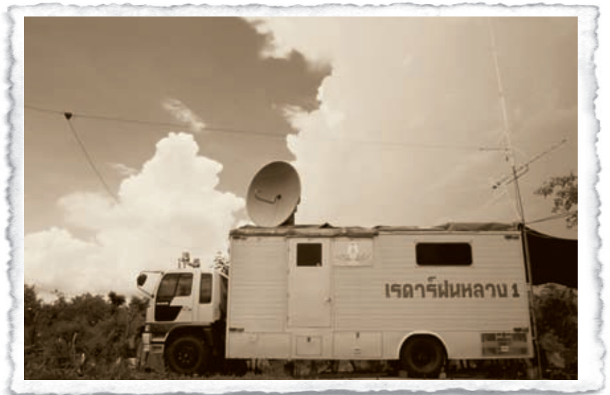
Специализированный автобус, оснащенный радаром для управления искусственным дождем.
