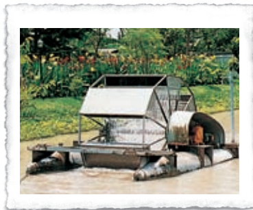
Турбина Чайпхаттана, сконструированная Его Величеством для насыщения воды кислородом.
