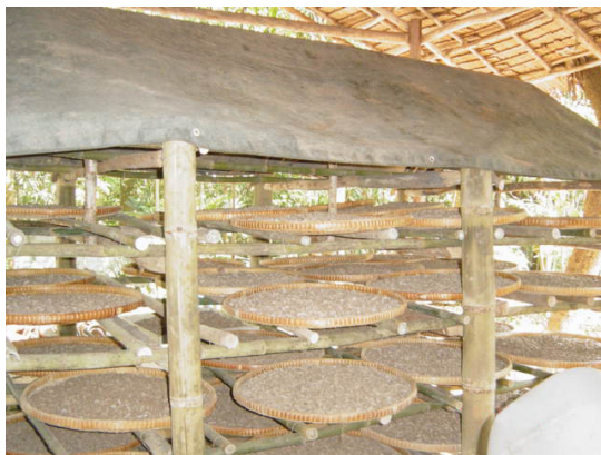
ลักษณะการบ่มปุ๋ยหมักอัดเม็ดบนกระเจาด
