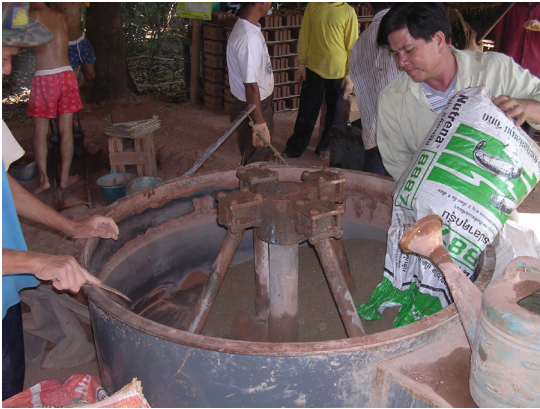
การเตรียมส่วนผสมของปุ๋ยหมักก่อนนำไปอัดเม็ดแล้วบ่ม
