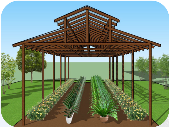
รูปที่ 3 แบบโรงเรือนปลูกพืชไม้ไผ่ทรงหลังคาจั่ว 2 ชั้นอย่างง่าย หน้ากว้าง 4 เมตร (ซ้าย) และ 6 เมตร (ขวา) ที่ปรับปรุงแบบใหม่เพื่อลดต้นทุนลงและสร้างได้ง่ายขึ้น
