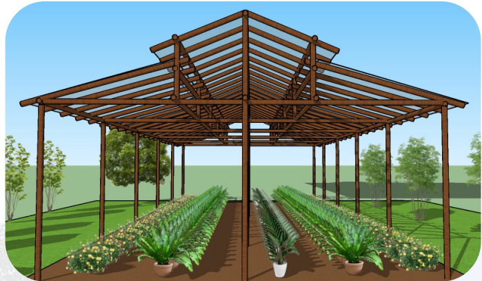
รูปที่ 3 แบบโรงเรือนปลูกพืชไม้ไผ่ทรงหลังคาจั่ว 2 ชั้นอย่างง่าย หน้ากว้าง 4 เมตร (ซ้าย) และ 6 เมตร (ขวา) ที่ปรับปรุงแบบใหม่เพื่อลดต้นทุนลงและสร้างได้ง่ายขึ้น
