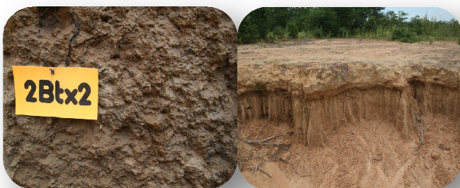
ลักษณะของชั้นดานเปราะ และปัญหาการกร่อนดินในพื้นที่ที่ พบชั้นดานเปราะ
