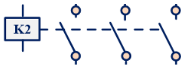
5. คอนแทคเตอร์หมุนซ้าย = K2 (Reverse Contactor)
