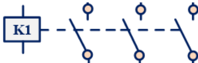
7. คอนแทคเตอร์หมุนขวา = K1 (Forward Contactor)
