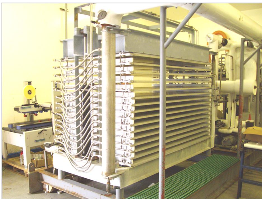
รูปที่ 8-5 การแช่แข็งด้วยแผ่นโลหะให้ความเย็น (plate freezing)
