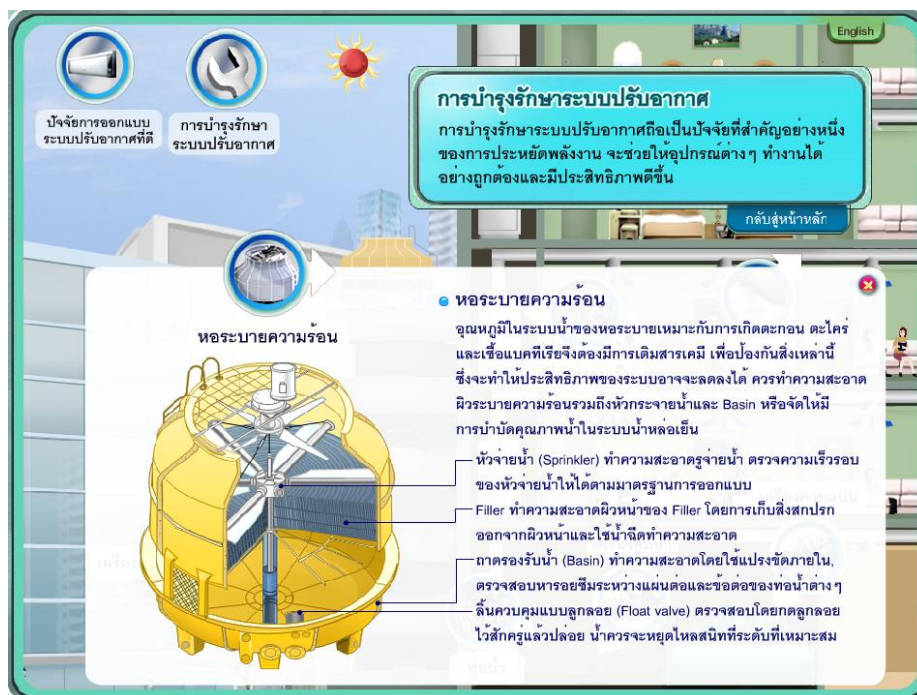
รูปที่ 8-42 การบำรุงรักษาหอระบายความร้อน
