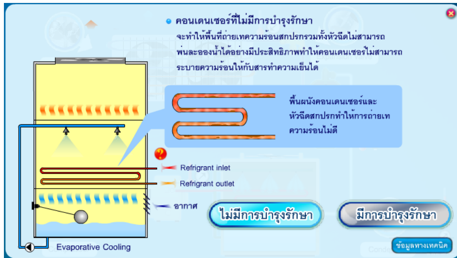
รูปที่ 8-21 อุปกรณ์คอนเดนเซอร์ที่ไม่มีการบำรุงรักษา
