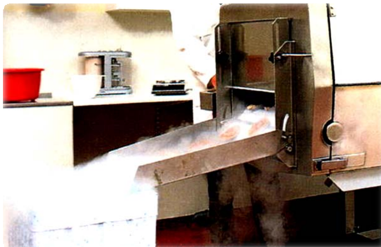
รูปที่ 8-7 การแช่แข็งด้วยก๊าซเหลว (freezing with liquidified gasses)
