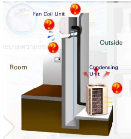
รูปที่ 8-41 การบำรุงรักษาเครื่องปรับอากาศแบบแยกส่วน
