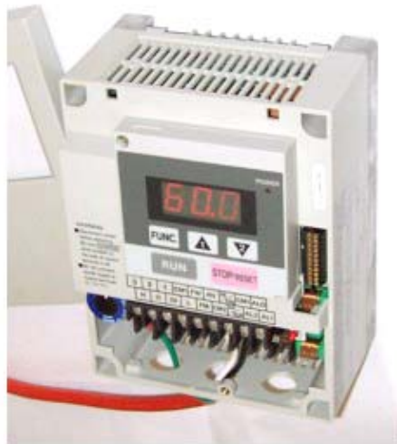
รูปที่ 4-4 อุปกรณ์ควบคุมความเร็วรอบมอเตอร์
