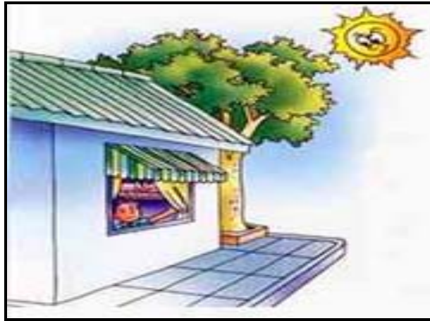
รูปที่ 13-30 การปลูกต้นไม้ และติดตั้งกันสาดที่ด้านนอกอาคาร
