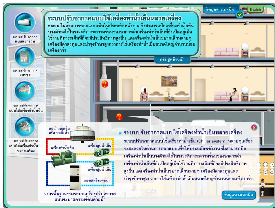
รูปที่ 13-17 ระบบปรับอากาศแบบใช้เครื่องทำน้ำเย็นหลายเครื่อง
