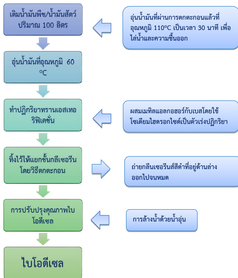
รูปที่ 15-13 แสดงแผนผังกระบวนการผลิตของเครื่องไบโอดีเซลชุมชน
