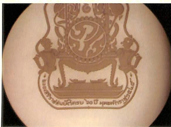
ภาพผ่านกล้องจุลทรรศน์ แสดงลวดลายที่บแสง อัลตราไวโอเลต ของตราสัญลักษณ์ บนกระจกต้นแบบ
