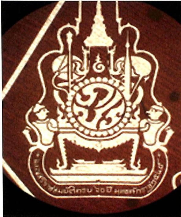
ภาพจากกล้องจุลทรรศน์ แสดงแม่พิมพ์พอลิเมอร์ หนาประมาณ 200 ไมโครเมตร บนแผ่นเหล็กสแตนเลส หลังจากการฉายแสงซินโครตรอนและล้างฟิล์ม
