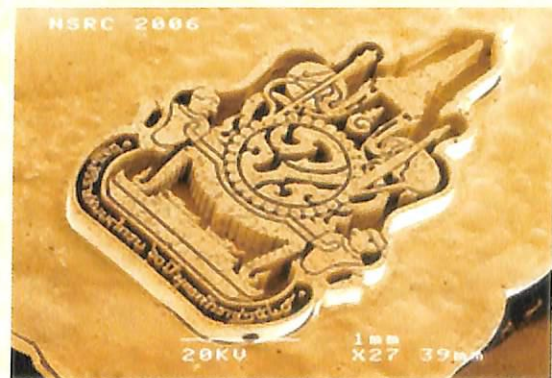
ภาพจากกล้องจุลทรรศน์อิเล็กตรอน แสดงคราสัญลักษณ์บนแผ่นฐาน निकเกิลหลังชุบทอง
