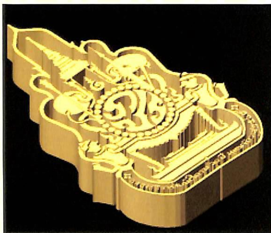
ภาพจำลองสามมิติของตราสัญลักษณ์ ฉลองสิริราชสมบัติครบ 60 ปี แบบลายเส้นจุลภาค ลายเส้นตัวหนังสือไทยกว้าง 15 ไมโครเมตร
