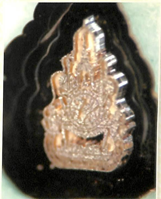
ภาพจากกล้องจุลทรรศน์แสดงคราสัญลักษณ์ บนแผ่นฐาน निकเกิลซึ่งแยกออกมาจากแผ่นสแตนเลสแล้ว
