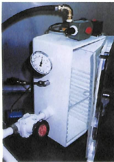
ภาพแสดงเครื่องยิงอนุภาคที่ประดิษฐ์ขึ้นมาใช้เอง สำหรับการถ่ายยีนและอุปกรณ์ประกอบ
