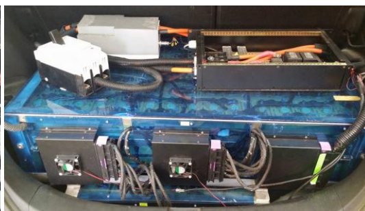
แบตเตอรี่ติดตั้งอยู่ส่วนท้ายของห้องโดยสาร
