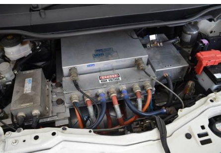
ภายในห้องเครื่องรถยนต์ไฟฟ้าดัดแปลงต้นแบบติดตั้งชุดจ่ายกระแสไฟฟ้าอิชียูและมอเตอร์กำลังสูง
