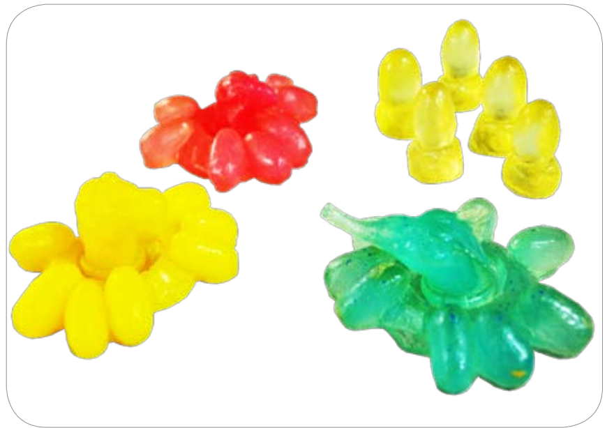
ตัวเดินรุ่นแรก (ภาพซ้าย) และรุ่นที่สอง (ภาพขวา) ทำจากเรซินที่หล่อเองจากมือ โดยทำแม่แบบเอง
