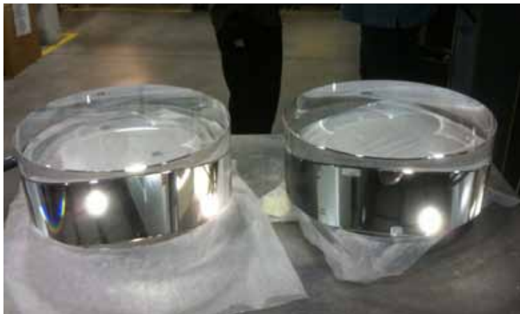
กระจกที่โลโก้ใช้ ซึ่งทำจากซิลิกาบริสุทธิ์ แต่ละชิ้นหนัก 40 กิโลกรัม (ภาพ: Caltech/ MIT/ Ligo Lab)
