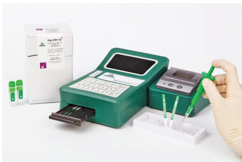
ภาพที่ 6.16 การอ่านค่าความเข้มข้นสารพิษจาก strip โดยเครื่องอ่าน ที่มา: www.romerlabs.com
