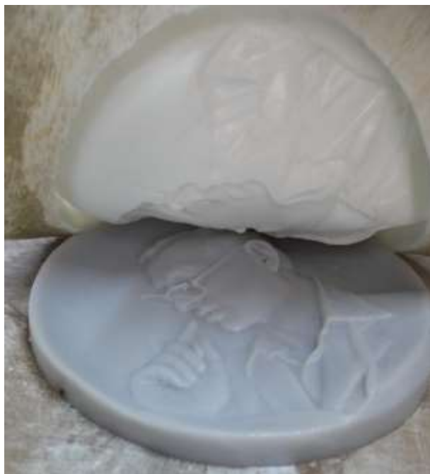
ขั้นตอนการถอดชิ้นงานออกจากแม่พิมพ์ยางซิลิโคน
