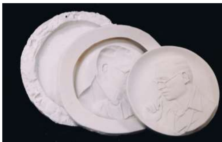
พิมพ์ครอบ พิมพ์ยางซิลิโคน และตัวแม่พิมพ์ต้นแบบ
