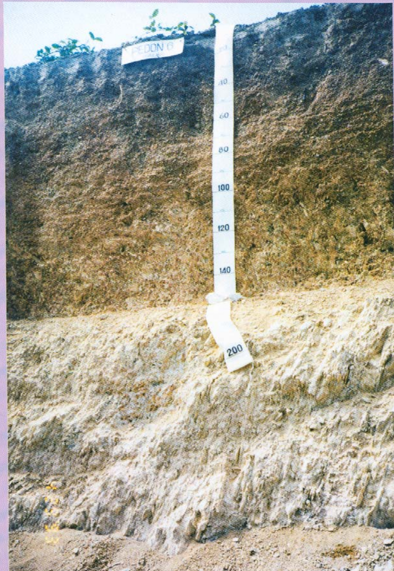
รูปที่ 2 แสดงหน้าตัดของชุดดินกบินทร์บุรี (กลุ่มชุดดินที่ 46) มีความเหมาะสมดี สำหรับการใช้เป็นดินถมหรือดินคันทาง
