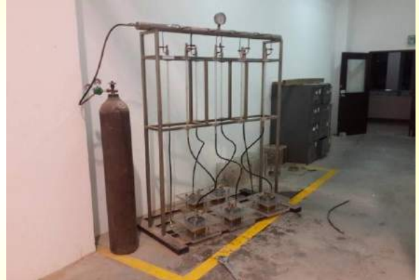
ภาพที่ 1 นำเซลล์บล็อกติดตั้งที่เครื่องทดสอบ
