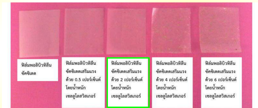
ภาพ ฟิล์มพอลิบิวทิลีนซัคซิเนตเสริมแรงด้วยเซลลูโลสวิสเกอร์จากกากปาล์มน้ำมัน
