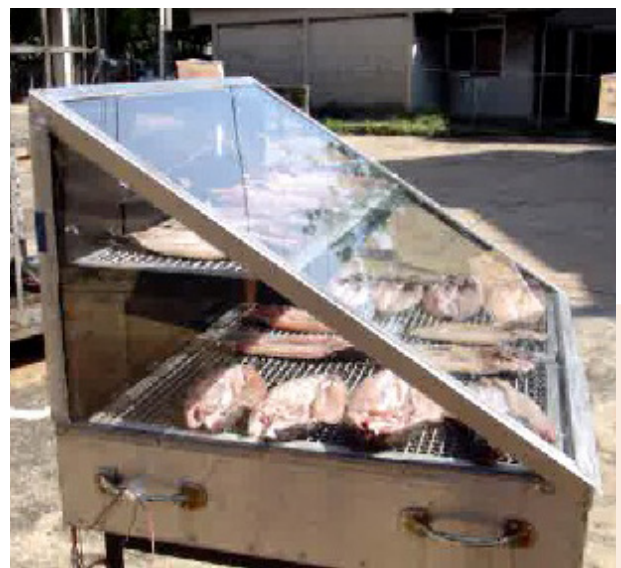
รูปที่ 3 ตู้อบแห้งพลังงานแสงอาทิตย์ ระดับครัวเรือน ขนาด 5 กิโลกรัม/วัน
