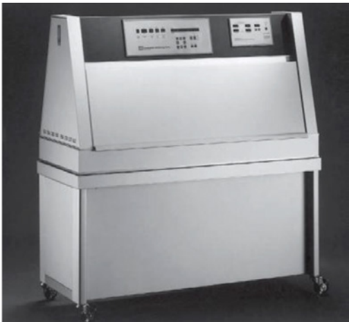
รูปที่ 3 ชุดอุปกรณ์การทดสอบและหลักการการทดสอบโดยจำลองสภาพอากาศด้วยแสงยูวีและความชื้น
