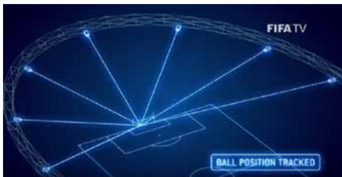
กล้องบันทึกภาพความไวสูงจำนวน 7 ตัว ติดตั้งในมุมสูง อยู่ด้านหลังประตู
