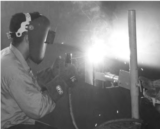
รูปที่ 6 ตำแหน่งทำเชื่อมแบบทำตั้ง (vertical)
