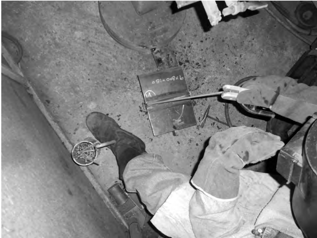
รูปที่ 4 ตำแหน่งทำเชื่อมแบบทำราบ (flat)
