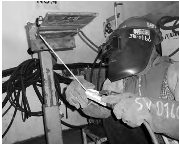
รูปที่ 7 ตำแหน่งทำเชื่อมแบบทำเหนือศีรษะ (overhead)
