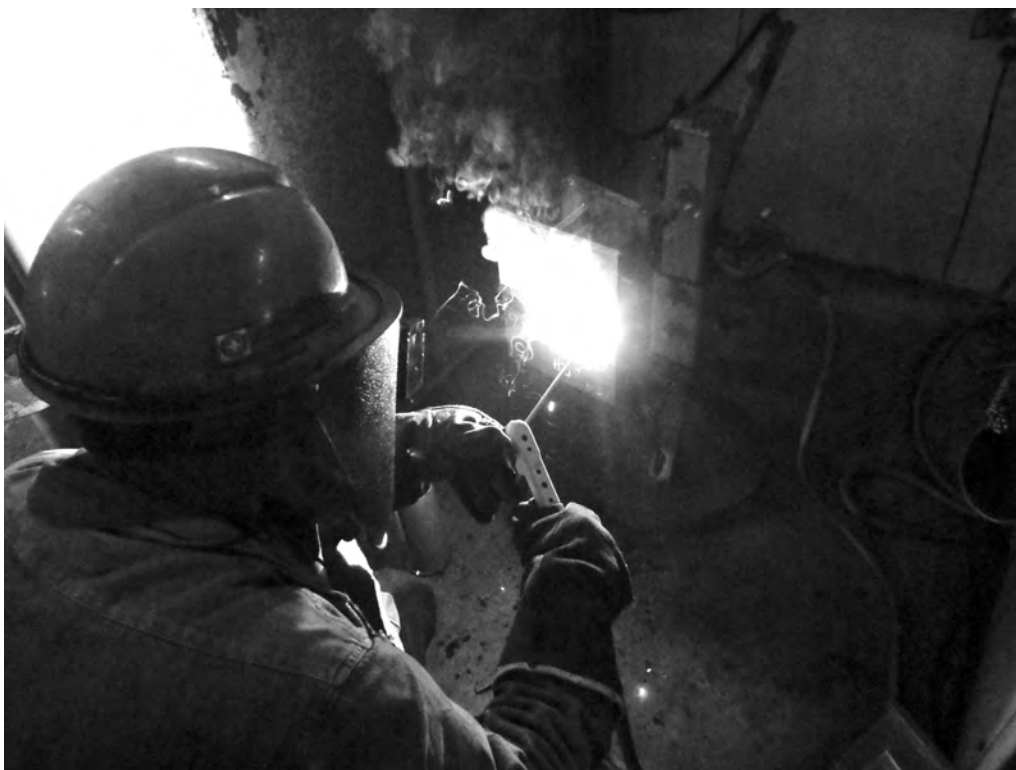
รูปที่ 5 ตำแหน่งทำเชื่อมแบบทำขนานนอน (horizontal)
