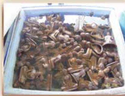
การทำพระขี้ผึ้งสำหรับงานหล่อ
