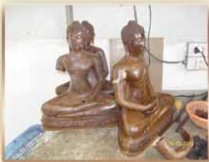
การทำพระขี้ผึ้งสำหรับงานหล่อ
